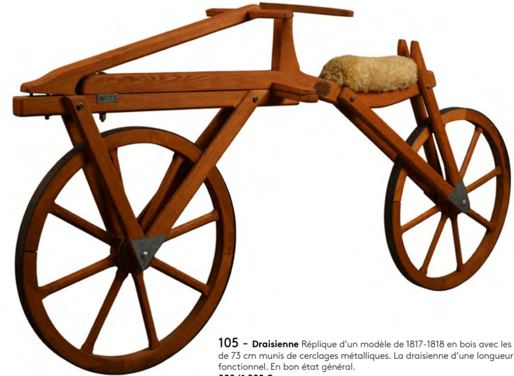
**105 - Draisienne** Réplique d'un modèle de 1817-1818 en bois avec les deux roues d'un diamètre de 73 cm munis de cerclages métalliques. La draisienne d'une longueur de 2m20 à un dirigeoir fonctionnel. En bon état général.
